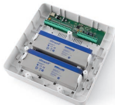
Boîtier Silenya hybride avec carte 8 entrées filaires
